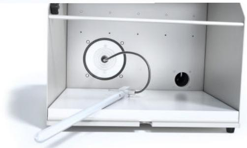
**LabTEC-X ist ein Corona-System, das für den Gebrauch unter Laborbedingungen optimiert ist. Da das System zu Testzwecken verwendet wird, wird ein Generator eingesetzt, der eine besonders exakte Regelung ermöglicht. Durch die rein manuelle Bedienung stellt das System eine sichere Ergänzung für jedes Labor dar. Die Elektrode hat einen isolierten Griff, der die manuelle Behandlung einer Vielzahl an Teilen ermöglicht.**
